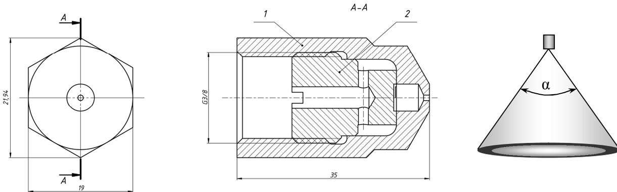
Форсунки серии **ТФ06** изготавливаются из латуни **ЛС63**. По специальному запросу форсунки могут быть изготовлены из нержавеющей стали **12Х18Н10Т**
